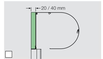
Kastendämmung rückseitig für Abstand-Führungsschiene mit 20 oder 40 mm
